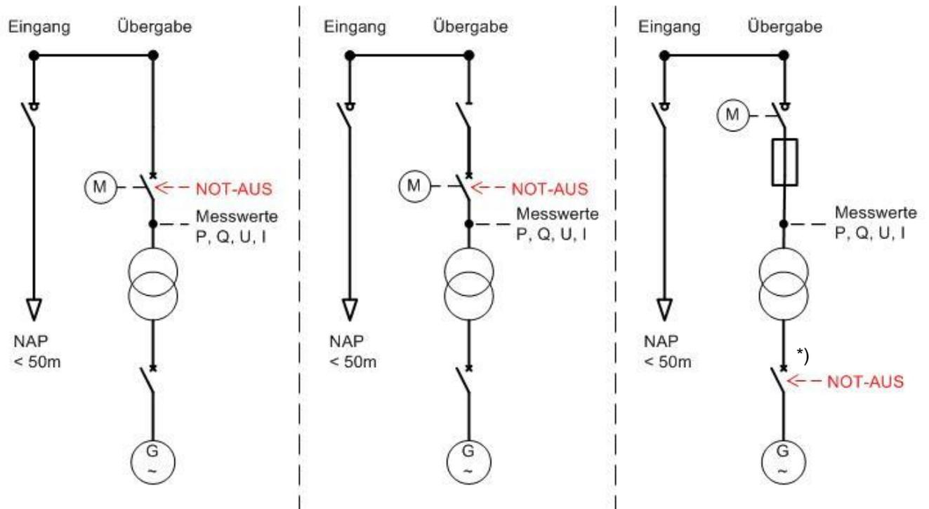
\*) Schutz- und Schaltgeräte redundanz (zwei Leistungsschalter) gemäß techn. Anschlussbedingungen beachten. Aus-Befehl auf denjenigen Leistungsschalter, auf den auch der übergeordnete Entkopplungsschutz wirkt.
