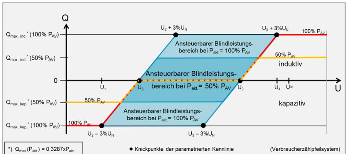
Bild 2.5: EZA vom Typ B: Q(U)-Verhalten (orange) bei  $P_{akt.}=50\%P_{AV}$  und Q-Soll=0 sowie der ansteuerbare Blindleistungsbereich (dunkelblau) für Q-Soll $\neq$ 0; Q(U)-Verhalten (rot) bei  $P_{akt.}=100\%P_{AV}$  und Q-Soll=0 sowie der ansteuerbare Blindleistungsbereich (hell- und dunkelblau) bei Q-Soll $\neq$ 0
