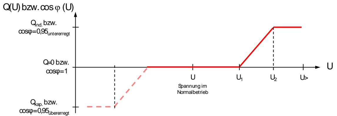
Bild 9.1: Qualitative Darstellung des spannungsabhängigen Blindleistungsverhaltens von Erzeugungsanlagen
